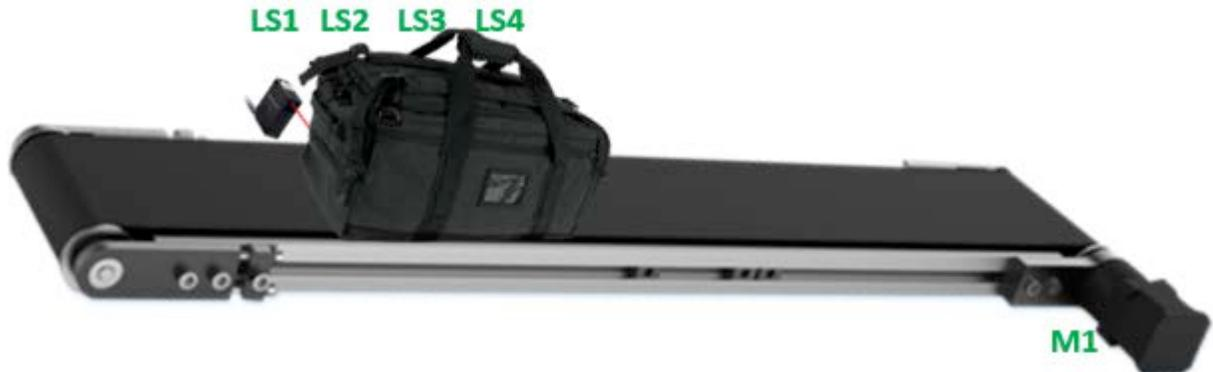
Lorsque le 4ème détecteur de proximité est activé, si tous les capteurs (LS1, LS2 et LS3) détectent, cela signifie qu'un bagage surdimensionné en longueur se trouve dans la bande de tri et les événements suivants se produisent :
