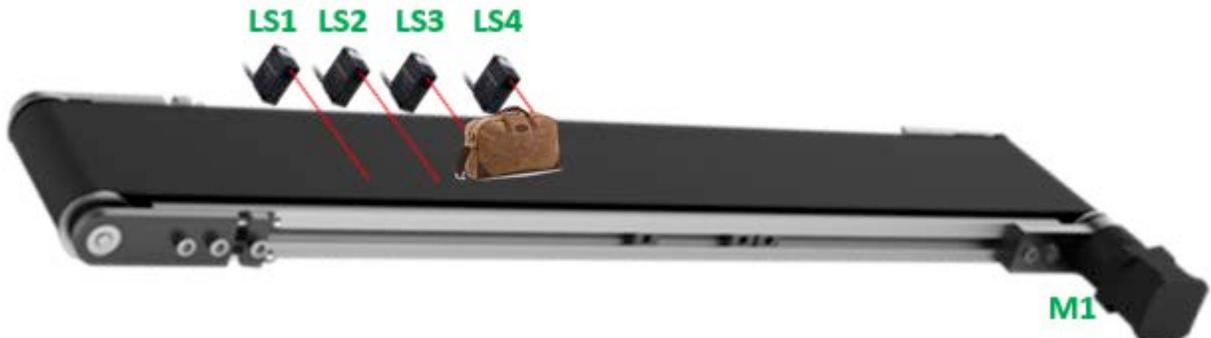
Lorsque le 4ème capteur de proximité est activé, si seul le 3ème capteur (LS3) est en train de détecter, cela signifie qu'un petit bagage est sur la courroie de tri et que les événements suivants se produisent:
