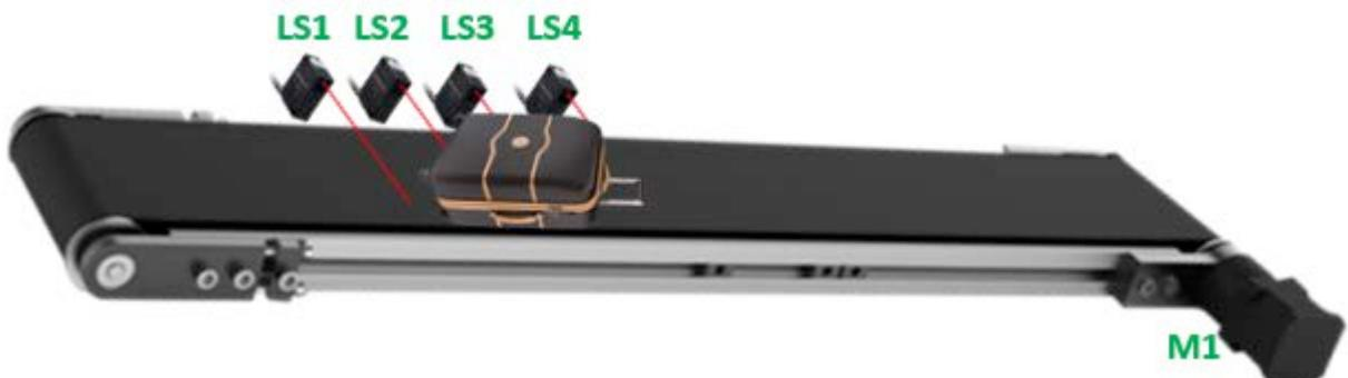
Lorsque le 4ème capteur de proximité est activé, si seulement les 2ème et 3ème capteurs LS2 & LS3 détectent, cela signifie qu'un bagage de taille régulière est sur la courroie de tri et ce qui suit se produira :
