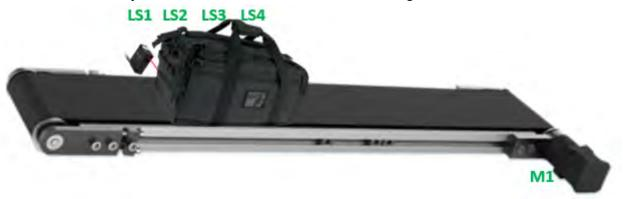
Lorsque le 4<sup>e</sup> détecteur de proximité est activé et que tous les capteurs (LS1, LS2 et LS3) détectent eux aussi un objet, cela signifie qu'une valise surdimensionnée en raison de sa longueur se trouve sur la courroie de tri. Les actions suivantes se produisent :
