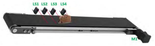
Lorsque le 4<sup>e</sup> capteur de proximité est activé et que seulement le 3<sup>e</sup> capteur (LS3) détecte lui aussi un objet, cela signifie qu'une valise de petite taille est sur la courroie de tri. Les actions suivantes se produisent :
