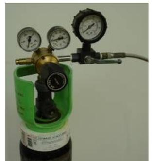
La pression sera déterminée par la relation pression/température du réfrigérant à utiliser lorsqu'elle est appliquée aux valeurs ci-dessus. Les concurrents et les concurrentes, en présence d'un juge, doivent consigner la pression d'essai du système indiquée sur le régulateur ou le manomètre.
