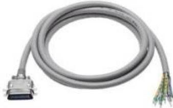
**Conception :** Un connecteur d'extrémité Syslink à 24 broches, l'autre extrémité étant ouverte avec des ferrules. Les broches 9 et 10, 21 et 22, 23 et 24 sont interconnectées.
