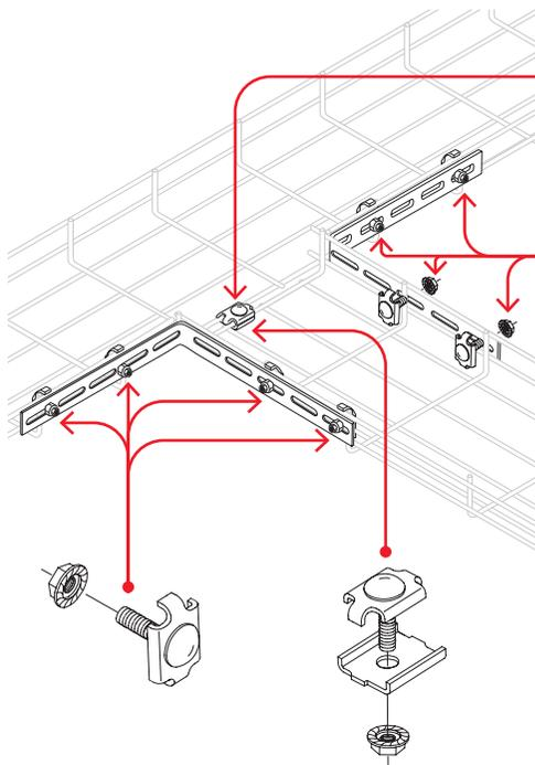
• Pour former le té horizontal, positionnez une section de chemin à la perpendiculaire avec une deuxième section et les joindre à l'aide de l'éclisse universelle illustrée en page B16.
