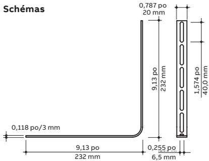
\* Composants de l'ensemble : un (1) support 90 degrés (ETA-H90-HD), quatre (4) brides de fixation (ETH-WBC-HD) et une (1) éclisse universelle (ETH-SP-HD)
