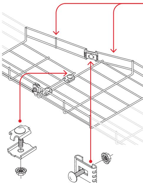
Pour raccorder les sections de profilé, utilisez une combinaison d'éclisses universelles et d'éclisses réglables décrites aux pages B16–B17.
