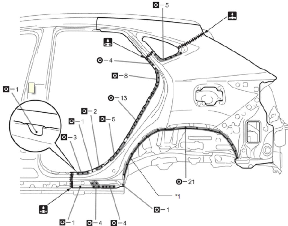
Soudez la section 3 avec une soudure en bouchon.
